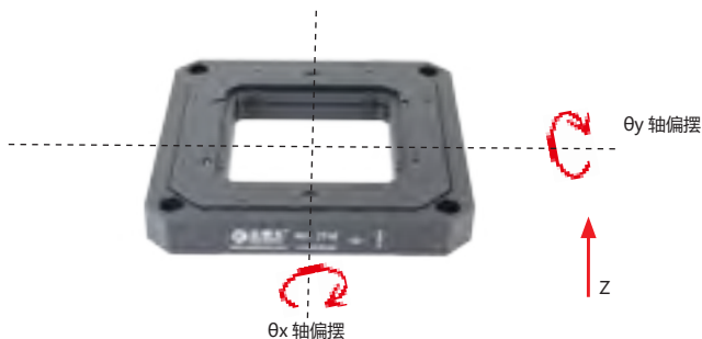
图 2 S51.ZT1S/K 压电偏摆台运动方向
