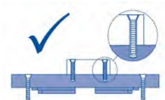
图 7 正确的螺栓连接方式
