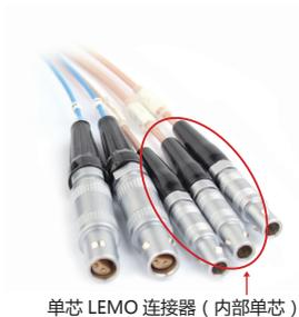
进入模式后可以设置输出电压值，如 10V、60V、120V 等，同时在 OUTPUT 端口使用万用表测试对应输出电压（单芯 LEMO 连接器内芯为正极、外壳为负极，如不是 LEMO 连接器请按厂家给出的接线定义测试），若与设置输出的电压值一致，则无异常，否则可联系厂家处理（联系方式见附录）。
