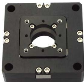
P16 系列压电扫描台为 XY 轴平移扫描台，机构放大设计原理，中心通孔孔径为 20mm，该系列扫描台有 50 $\mu\text{m}$  与 100 $\mu\text{m}$  两种规格行程可选，开环闭环可选。方形移动台面，便于与外部机械结构安装连接。
