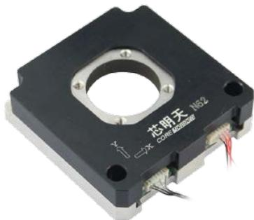
N62 系列压电扫描台为 XY 轴平移扫描台，机构放大设计原理，中心通孔孔径为 26mm，可以实现 XY 轴  $\pm 11\mu\text{m}$  的位移行程，产品体积小、结构紧凑易于集成与安装。
