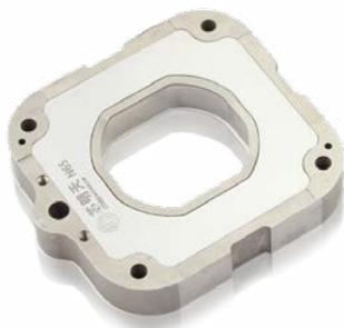
N65 系列压电扫描台为 XY 轴平移扫描台，采用 XY 轴一体式结构设计压电陶瓷直驱机构，中心具有通孔尺寸为 25×27.5mm，产品体积小、性能稳定，N65 系列扫描台为开环版本、动态性好，适用于动态扫描应用领域。
