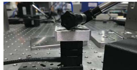
使用电容测微仪进行位移测量
