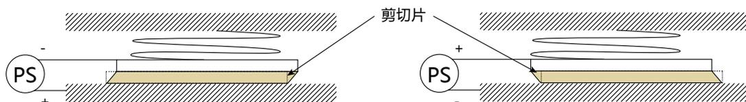
如果使用夹持力，负载机构在致动方向的刚度应尽可能的低，以避免阻碍剪切片的运动。
