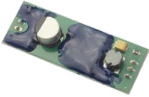
压电纤维复合材料 MFC 传感器可产生与形变成比例的电荷，可以将这些电荷能量进行收集用于限定的电应用要求。
