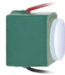
压电陶瓷粘接镜片效果
