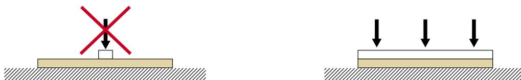
负载必须作用在整个表面，以确保力的均匀分布。特别是施加压力时，接触面一定要足够平整。
