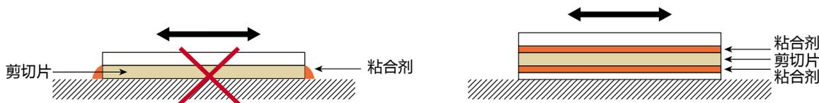
如使用胶水来固定剪切片，一定要确保剪切片与基片间的胶层非常薄，一般可以使用较低粘度的胶水，在固化过程应使用一定的压力，例如 2-3MPa。
