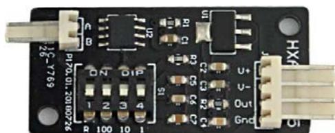
板卡式电荷放大器原理是将已接收的电荷转移给高阶、自由泄漏电容器，电荷通过电容，与电荷成正比的电压值将被特殊设计的接近空载的高电阻工作放大器测得，恒定的输出信号可持续达 3 分钟而没有明显的漂移。
