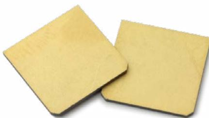
压电陶瓷剪切片的结构非常紧凑，厚度仅 0.5mm，谐振频率较高，达 1750kHz，它是利用压电陶瓷剪切向效应  $d_{15}$ ，通过施加双极性电压使得压电陶瓷产生切向位移，单片横向位移可达  $1.5\mu\text{m}$ 。压电陶瓷剪切片的上下面为金电极。可通过叠堆方式，组成多维运动或获取更大的位移。
