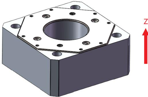
图 1 P77 压电扫描台运动方向
