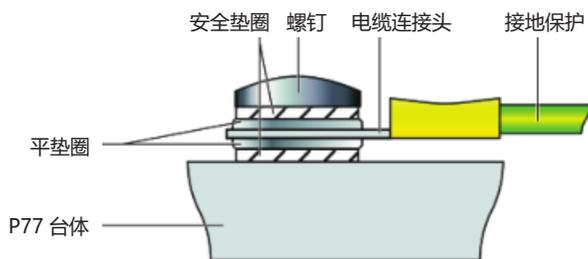
图 2 接地保护示意图
