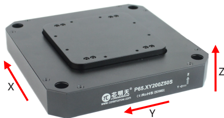
图 2 P65.XY200Z50 压电纳米定位台运动方向
