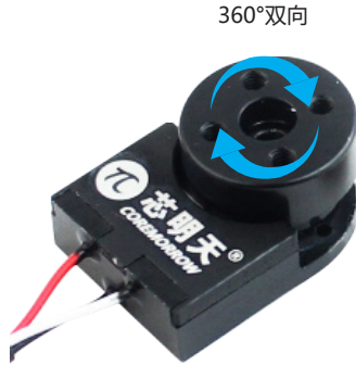
图 1 N69 旋转压电马达运动方向
