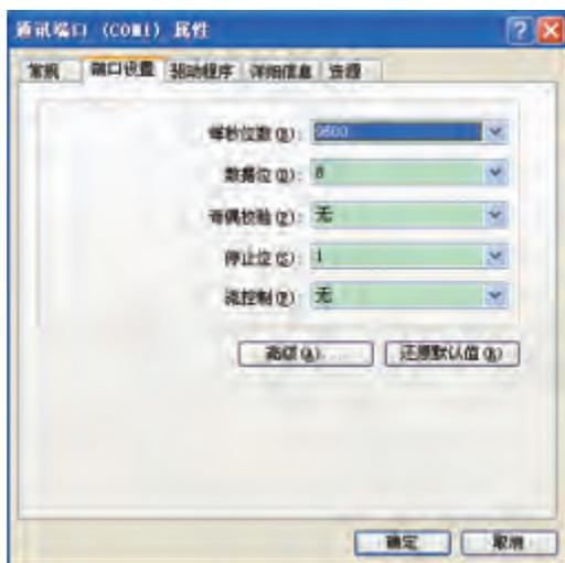
计算机软件通过 RS-232 串口控制时，在计算机界面可以选择串口通道及波特率，连接前请确认 COM 口和波特率是否与 E18 模块一致，否则连接失败。
