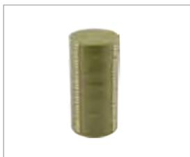
高压压电陶瓷是将单层压电陶瓷片与金属片电极层进行堆叠粘接，因此高压压电陶瓷为复合材料结构。相较于低压压电陶瓷，相同体积，静电容量比较低，在预载力的条件下动态性能更好。
