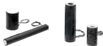
高压叠堆压电陶瓷是将单层压电陶瓷片与金属电极层交替叠堆粘接而成，标准驱动电压为0~500V、0~1000V，高压叠堆陶瓷因其出力大、静电容量低等特点，非常适用于大负载以及加载预载力后的动态应用。
