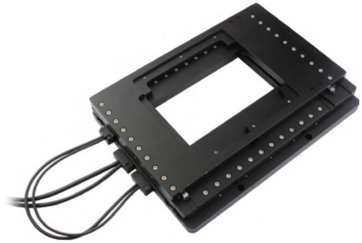
这款电动扫描台是X、Y二维的电动扫描台，采用直线/伺服电机驱，同时产品材质采用工业级阻燃外壳以及精加工铝合金基板、高精度滚珠导轨等材料制作而成。选择内置高精度传感器进行闭环微米级定位控制，产品可配套电动扫描台控制器。产品已经广泛应用于生物医疗、显微成像等领域。
